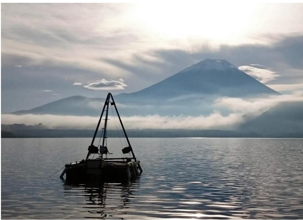
図1 本栖湖に浮かぶ掘削プラットフォーム。三角櫓からサンプラーを湖底に下ろす。
