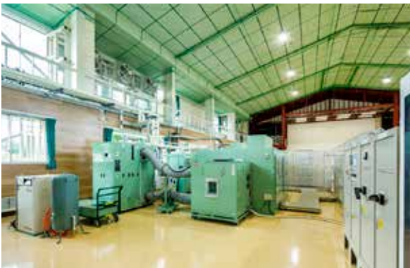
国内最大級のモーター特性試験装置 ※新世代モーター特性評価ラボに整備
