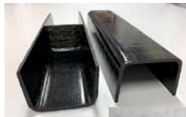
小規模設備で航空機レベル品質のCFRTP成形に成功
