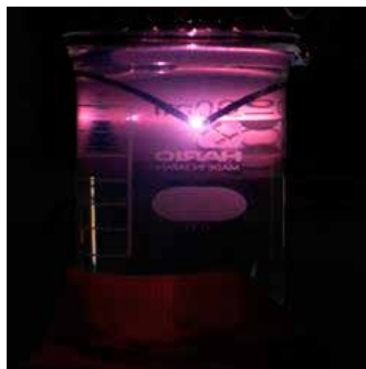
開発中の液中プラズマ装置による実験の様子
