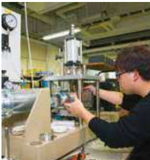
鳥海山から採取した泥流堆積物に対して定体積一面せん断試験を行う様子
