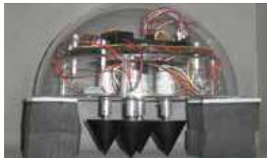
水面を移動しながらミストを放出する流体機械
