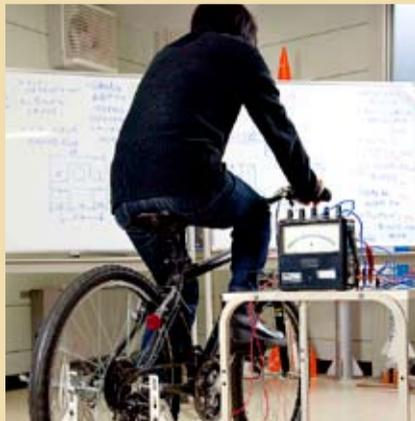
自転車を用いた小容量発電システムを構築。発生した電気エネルギーを蓄えることに成功。
