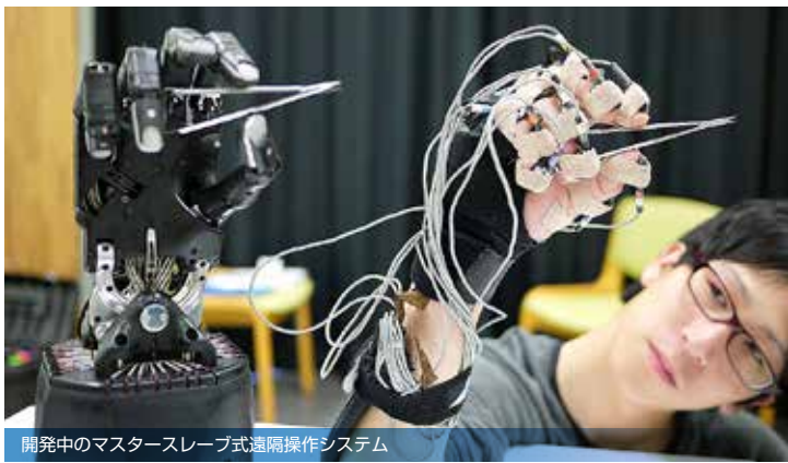
開発中のマスタースレーブ式遠隔操作システム
