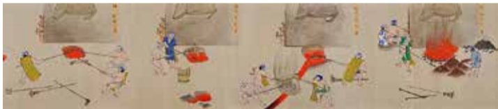
「阿仁鉱山 銅山働方之図」(部分): 絵巻は右から順に、焼鉱と木炭を加熱溶解してカラミを掻き出し、炉床の銅を掻き揚げている。
