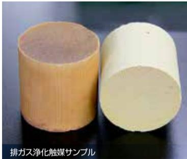
排ガス浄化触媒サンプル
