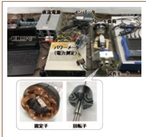
〈図2〉実験システム (設計・試作したモータを実験で評価)
