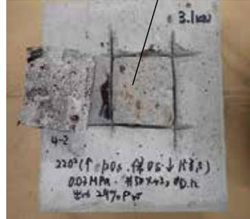
十分な付着(接着)強度を示す母材破壊モードを確認
