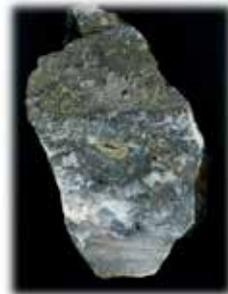
赤石鉱床の閃亜鉛鉱(Zn)・方鉛鉱(Pb)・重晶石(Ba)に富む鉱石
