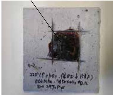
コンクリート母材の破壊面
