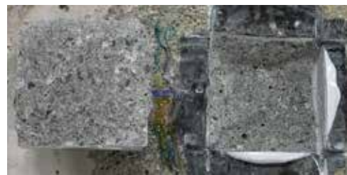
Figure 6 Destruction mode of resin at M_w : 8400 (モルタル表面が熱可塑性樹脂に接着したままはがれる母材破壊)
