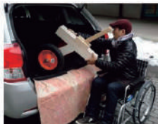
▲持ち難い ▲まっすぐ引き抜けない ●2輪安定性 :各所にグリップ：前輪ロック
