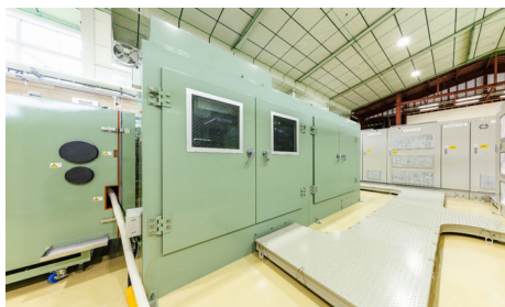
国内最大級のモーター特性試験装置 ※新世代モーター特性評価ラボに整備
