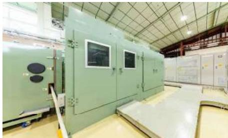
国内最大級のモーター特性試験装置
