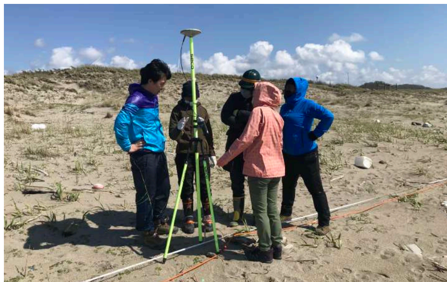
物理探査にともなう測量実習。衛星システムを用いて、電気探査の電極の位置を精密に測量しています。秋田市桂浜にて
